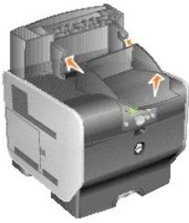
6. 向上旋转进纸匣，直到上部凸柱卡到上部插槽中。
