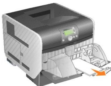
如果被卡的信封已进入打印机并且拉不出来，则取下信封进纸器。
