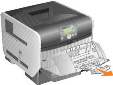
2. 朝着打印机向后抬起信封压盖。使它停在适当的位置上。
