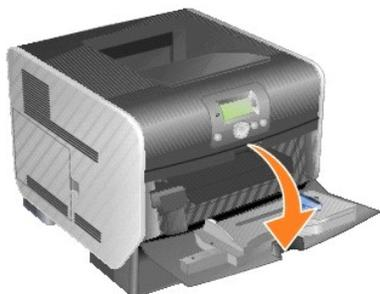
2. 将释放插销向右推来打开顶部前盖板。
